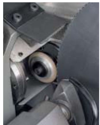
Option: Schleifen einer Spanteilernut bei kleinen Zahnteilungen ab 7 mm
