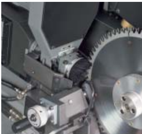
Hohlbrustschleifeinrichtung als Option
