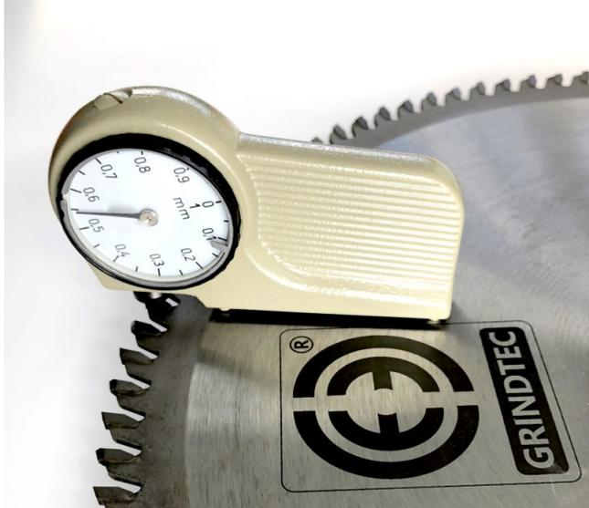
Jeder Fachmann kennt die Vorteile der richtigen Schränkung eines Sägeblatts. Mit Hilfe unserer Sägeschränkmessuhr kann eine Schränkung genau gemessen und das vorgeschriebene Maß eingehalten werden.
